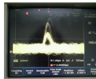
図 5.25: 中性子照射量 5.0 \times 10^{11} \text{ n/cm}^2 の HAPD(SHP107) での threshold scan 結果と 1 光電子信号のオシロスコープ画像。ASIC の整形時定数、HAPD の増幅率を変えた (HV を変更) 場合の結果。
