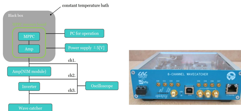
図 6.36 波高分布測定におけるセットアップ概念図 (右図) Wave Catcher の外観 (左図)
