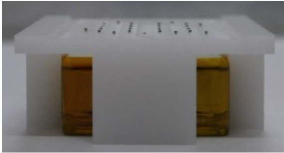
図 2.6 寸法検査の様子。写真上でジグから飛び出ているものが MCP-PMT のピン。
