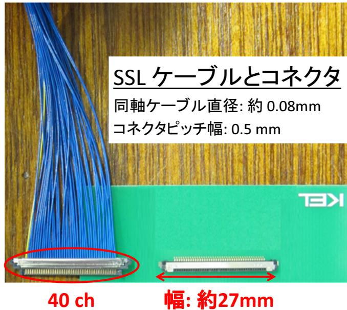
図 4.11: FE board 用ケーブルとコネクタ
