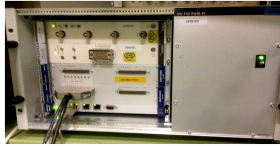
図 5.5 測定で使用した高圧電源の外観。左図は CAEN 社製電源、右図が ISEG 社製電源である。
