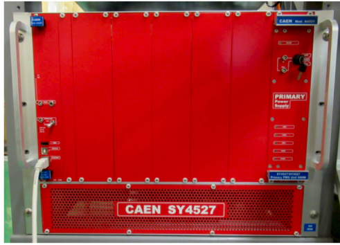
図 5.5 測定で使用した高圧電源の外観。左図は CAEN 社製電源、右図が ISEG 社製電源である。
