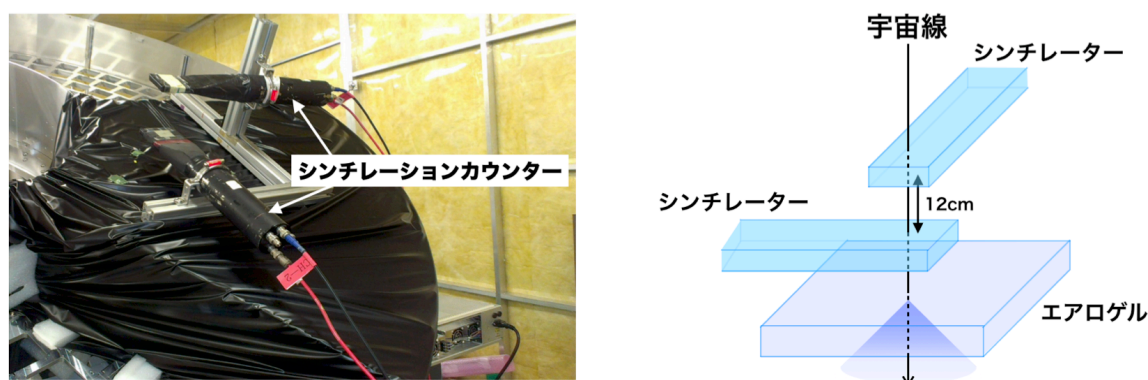
図 6.2 右図は宇宙線試験時の外観。左図は宇宙線トリガーの概要図。
