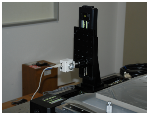
(b) CCD カメラは可動ステージに取り付けた。
