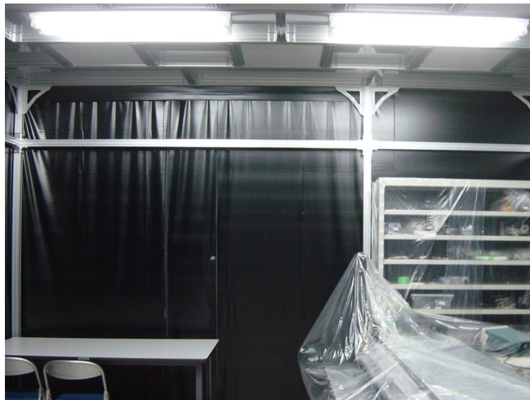
図 2.16: クリーンブース内部の写真。ブースの壁面は暗幕になっており、暗室としての機能も備えている。
