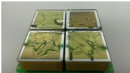
(c) PMT の入射窓に TSE3032 を塗る。
