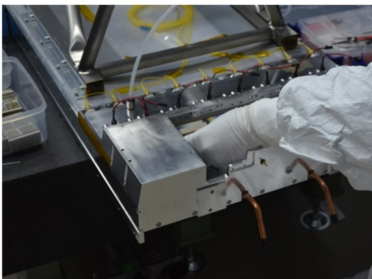
図 3.11 実機における PMT アセンブリの様子。プロトタイプよりもアクセスウィンドウが狭いが、取り付け作業は問題なく完了した。
