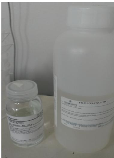
図 2.2 TSE3032。右が主剤の TSE3032(A)、左が硬化剤の TSE3032(B)
