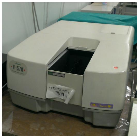
図 2.7 分光光度計 V-570 の外観。図中の開口部に測定サンプルを入れ、透過率の測定を行う。
