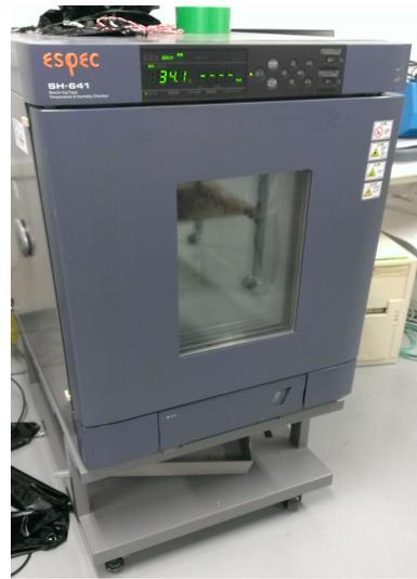
(d) 恒温槽で硬化させる。
