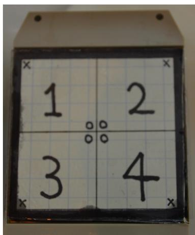
(a) 視野範囲確認のための PMT モジュール。
